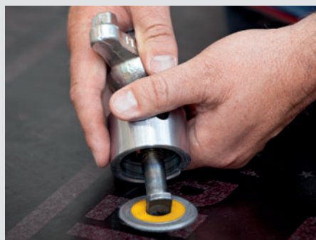
Zmiana uszczelki wymiennej z MX 15 ...
