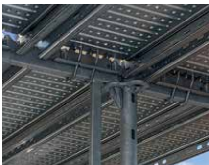
Integralne zabezpieczenie przed podnoszeniem: zintegrowany zaczep bezpieczeństwa automatycznie zachodzi pod prostokątny rygiel i w ten sposób zabezpiecza podest.
