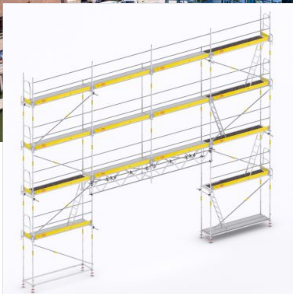
Dźwigary kratowe stosowane do podwieszeń ram, które nie mogą być stawiane od poziomu terenu, np. ze względu na bramę wjazdową
